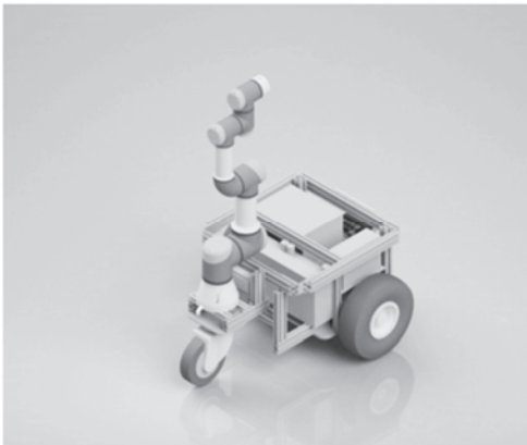
4. ábra. Robotmanipulátor elhelyezése a mobil platformon (CAD modell és prototípus)
