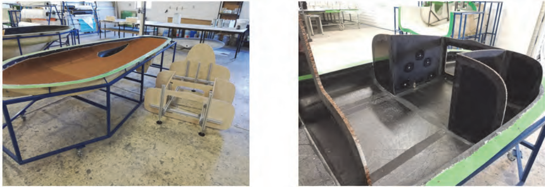
4. ábra Pozícionáló szerszám (balra) és belső falak ragasztva (jobbra)
