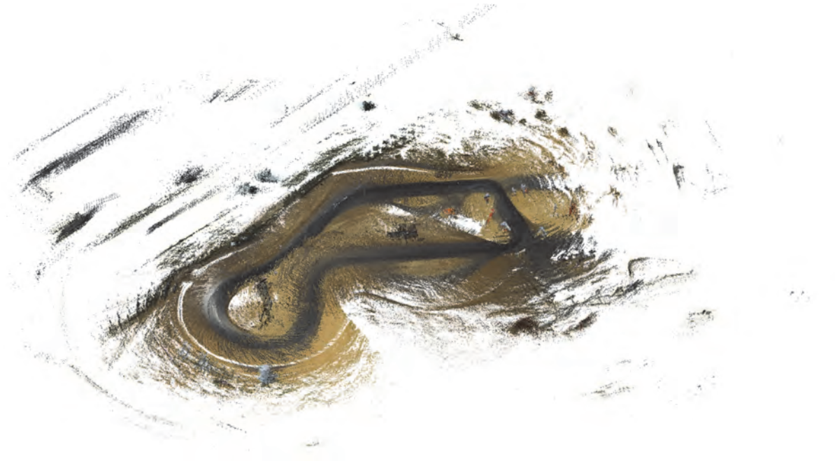
2.ábra. ZalaZone Egyetemi pályának a pontfelhő modellje RGB értékkel ellátott pontokkal
