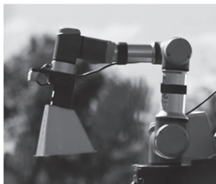
7. ábra. A terelőbója robotmanipulátorral történő megfogása
