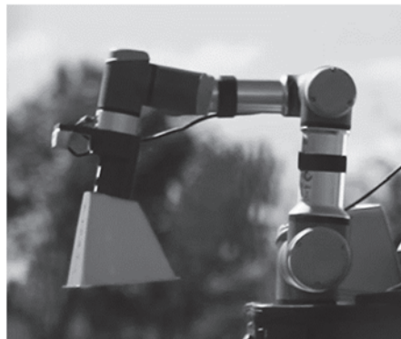
7. ábra. A terelőbója robotmanipulátorral történő megfogása
