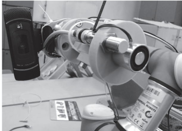
5. ábra. A megfogó prototípusa ideiglenes kamerával, fejlesztés alatt
