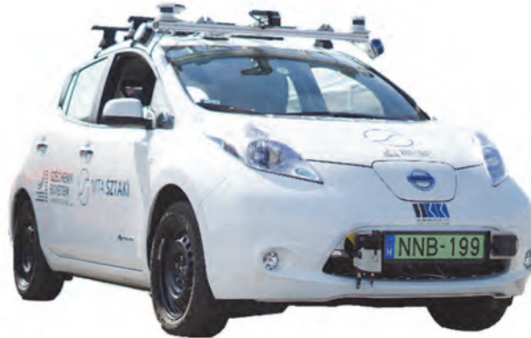
1. ábra Önvezető funkciók tesztelésére alkalmas átalakított elektromos autó
