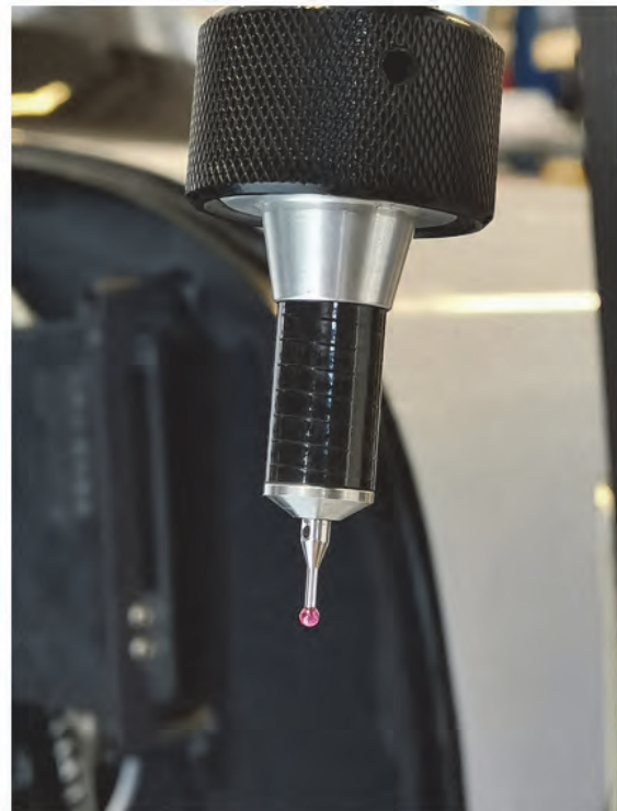
7. ábra Mérési pozíció felvétele (balra) és tapintócsúcsos mérőfej (jobbra)
