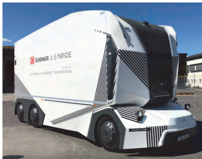
3. ábra. Vezetőfülke nélküli Einride Pod elektromos teherautó [12]
