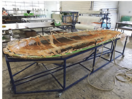
3. ábra Negatív alsó szerszám (balra) és karosszéria elem laminálása (jobbra)
