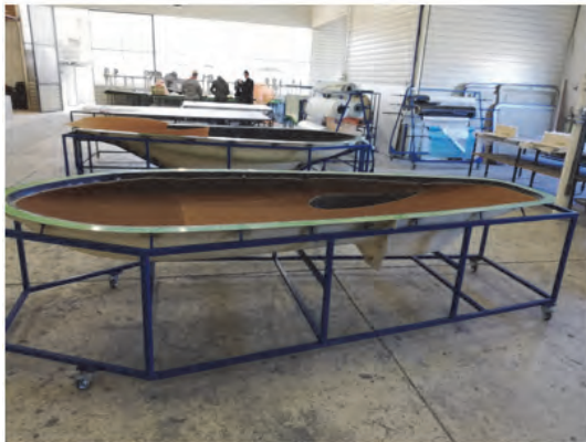
3. ábra Negatív alsó szerszám (balra) és karosszéria elem laminálása (jobbra)
