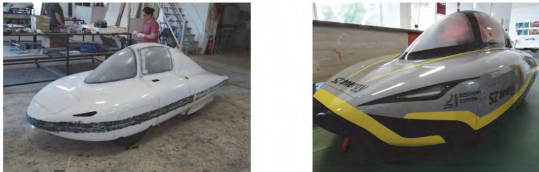
5. ábra Összeillesztett karosszéria elemek (balra) és fényezett, fóliázott jármű (jobbra)
