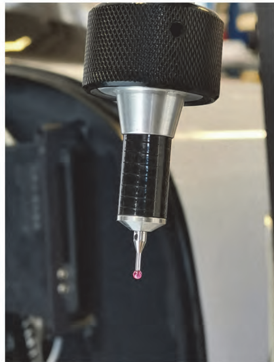
7. ábra Mérési pozíció felvétele (balra) és tapintócsúcsos mérőfej (jobbra)
