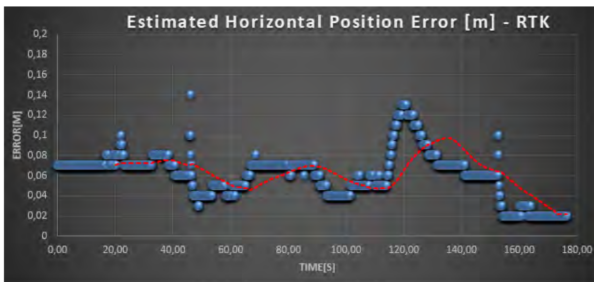
6. ábra: Becsült horizontális pontossági adatok RTK módban saját bázisállomás nélkül
