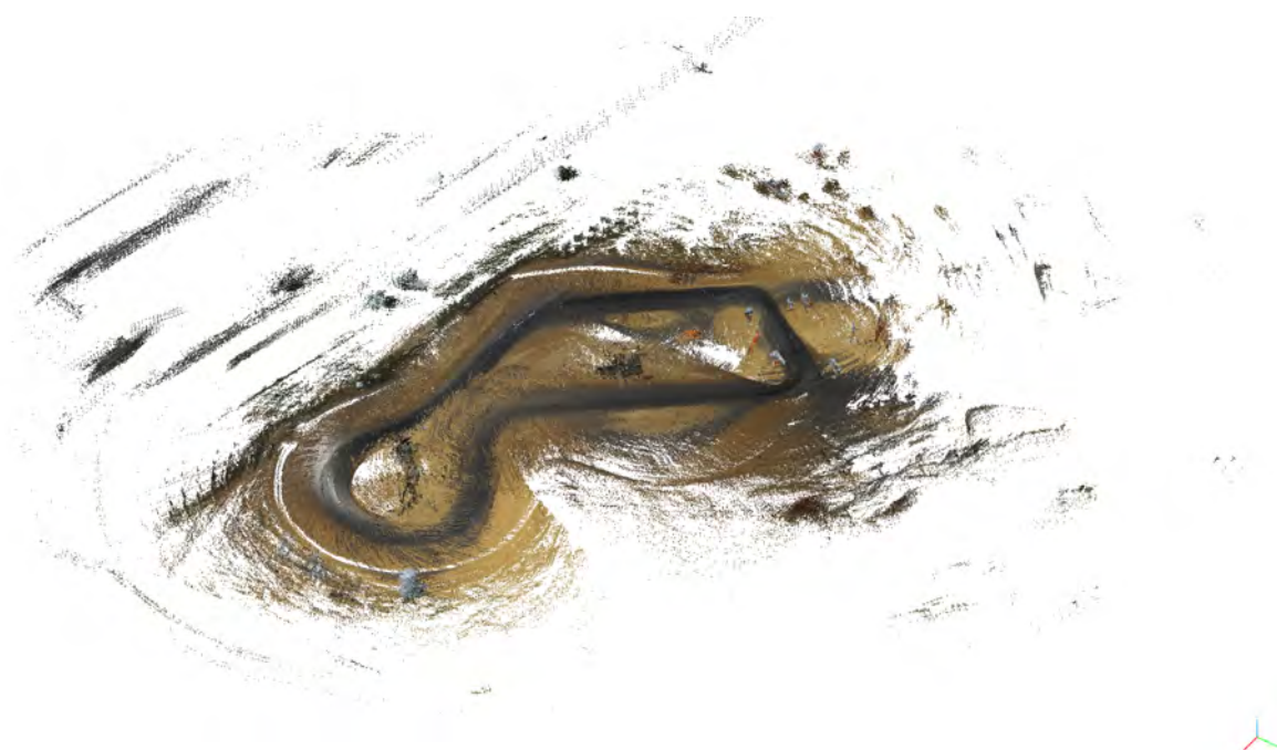
2.ábra: ZalaZone Egyetemi pályának a pontfelhő modellje RGB értékkel ellátott pontokkal
