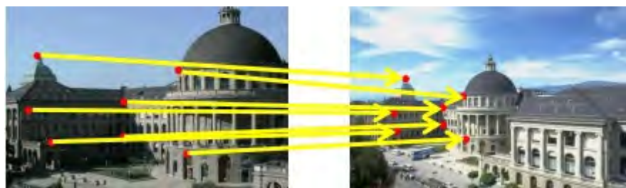
2. ábra: A főbb jellemzők detektálása a képsorozatokon [4]
