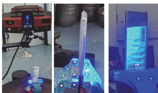
1. ábra Lítium polimer akkumulátor digitalizálása
