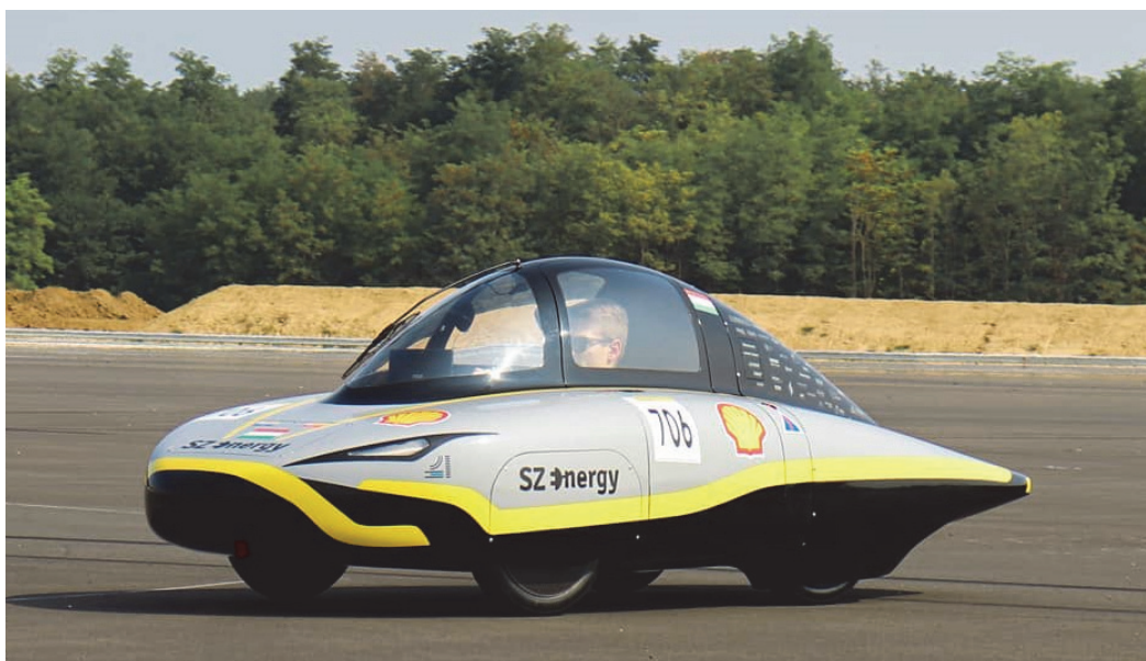
8. ábra - Menetellenállás mérés sorozat járműve a 2020-as járművel a ZalaZone tesztpályán
