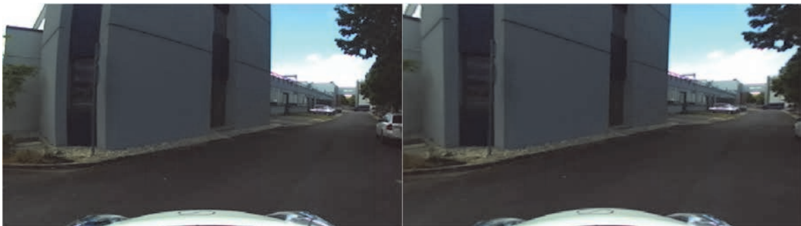
1. ábra: A kamera kalibrálás eredménye (balra: kalibrálatlan kép, jobbra: kalibrált kép)
