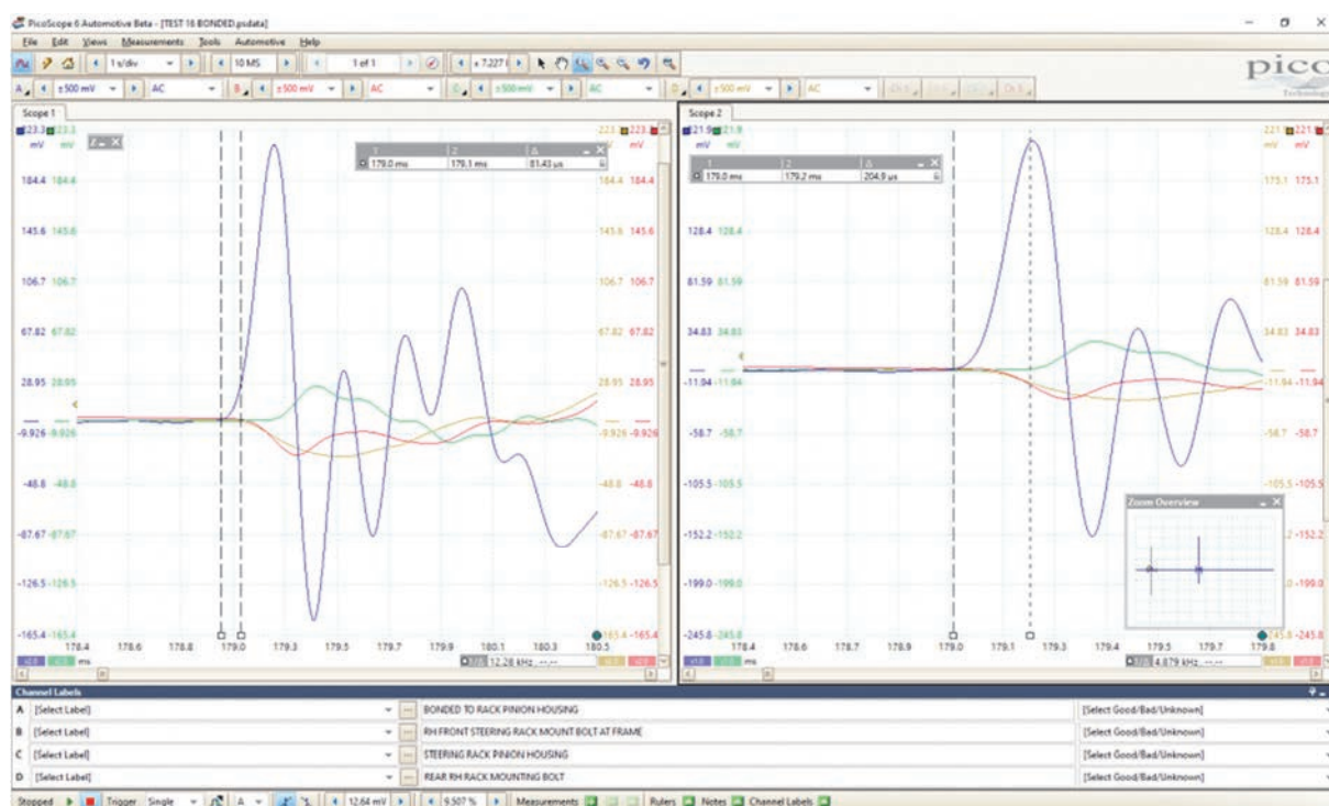
10. ábra: Hibafeltárás gyorsulásmérővel.
