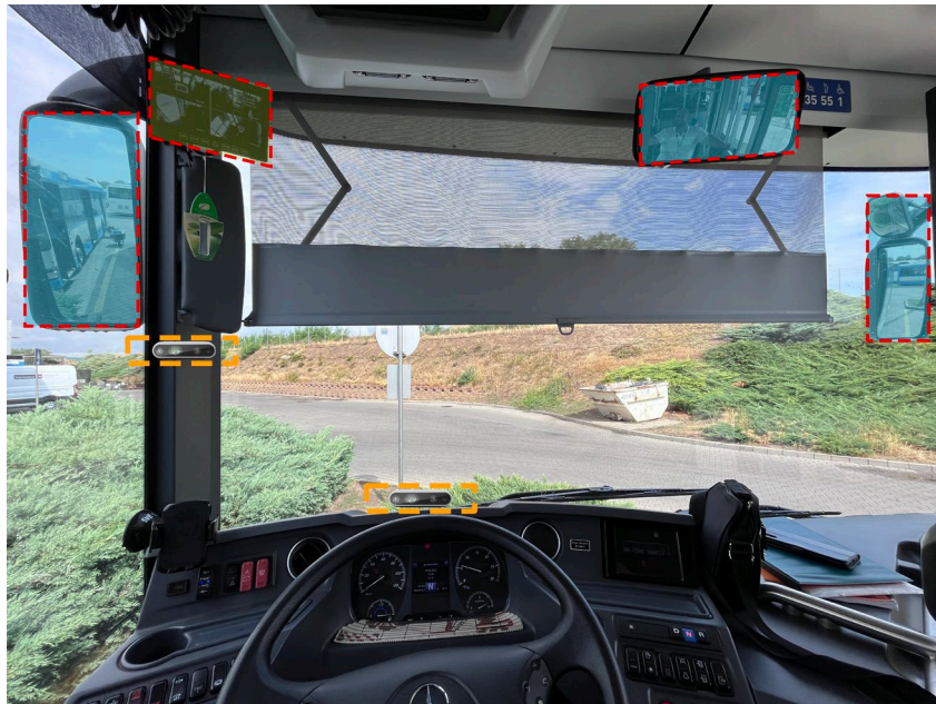
7. ábra: Az Intel RealSense kamera elhelyezési lehetőségei a vezetőhelyen (sárga szaggatott keret) piros szaggatott keret a visszapillantó tükröket és a fedélzeti kamerarendszer kijelzőjét jelölik (saját szerkesztés)
