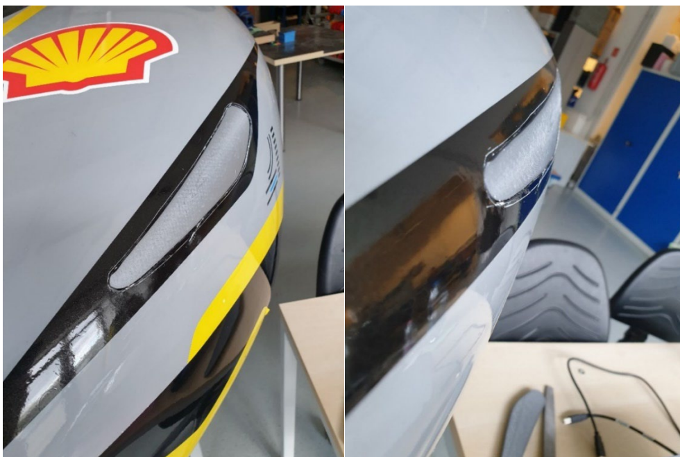
6. ábra: 3D nyomtatott próbatest illeszkedése a karosszériába (saját szerkesztés)
