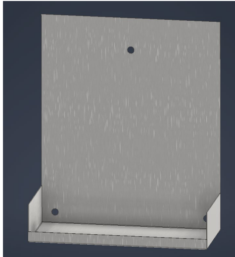
5. ábra: A topológiai optimalizálás kezdeti modellje (saját szerkesztés)
