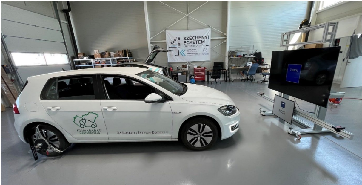
3. ábra: Volkswagen e-Golf kalibrációs folyamata, a szükséges kellékekkel (saját szerkesztés)
