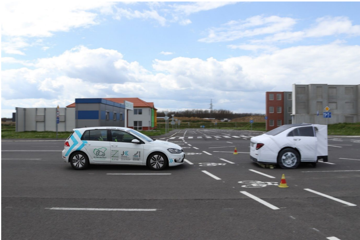
6. ábra: Vészfékkrendszer tesztelésének folyamata a ZalaZONE tesztpályán (saját szerkesztés)
