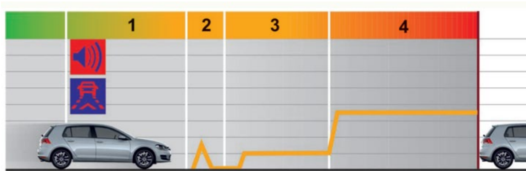
2. ábra: Automatikus vészfékrendszer működésbelépésének szakaszai VW Golf széria esetében [3]
