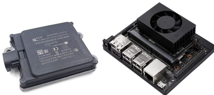
9. ábra: Continental ARS 408-21 radar, Jetson Xavier NX mikroszámítógép (saját szerkesztés)
