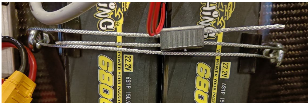
1. ábra: Az akkumulátor acélsodronnyal és kötélkapoccsal rögzítve (saját szerkesztés)
