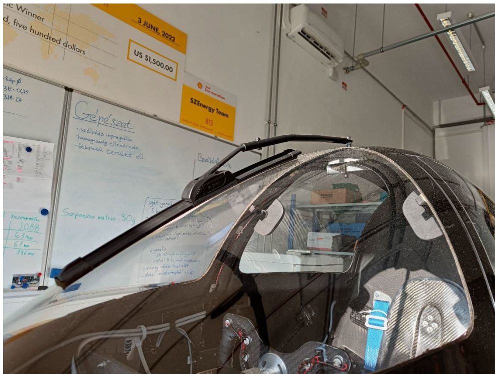
2. ábra: Egyedi formával – domborúsággal – rendelkező szélvédő (saját szerkesztés)
