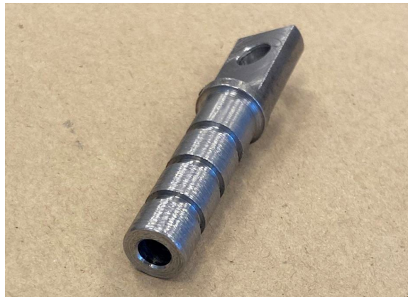
9. ábra: Insert - könnyítő furattal (saját szerkesztés)
