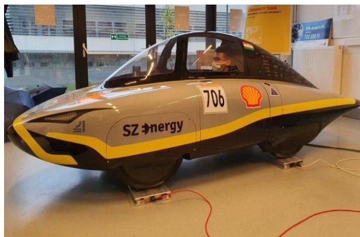
4. ábra: Talperőmérés folyamata [3]
