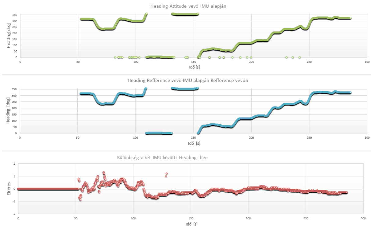
4. ábra: Két IMU Heading összehasonlítása
