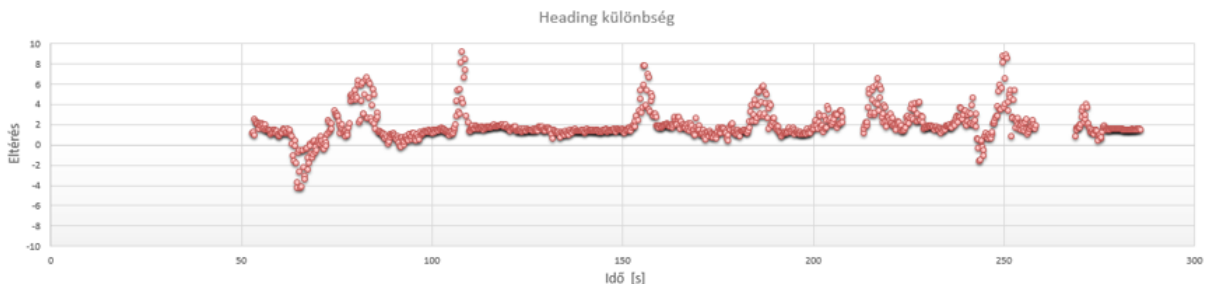
6. ábra: Dual-GNSS Heading és IMU Heading eltérés szűrt adatsorral
