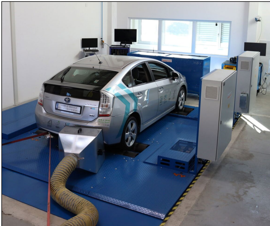
8. ábra: Mérendő jármű rögzítése a teljesítménymérő padon (saját szerkesztés)
