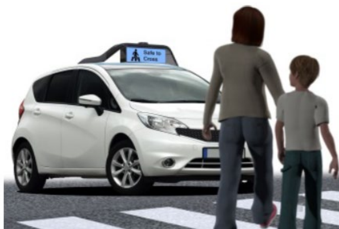
3. ábra: Szöveges üzenet egy autonóm járműre szerelt kijelzőn – Safe to cross 4
