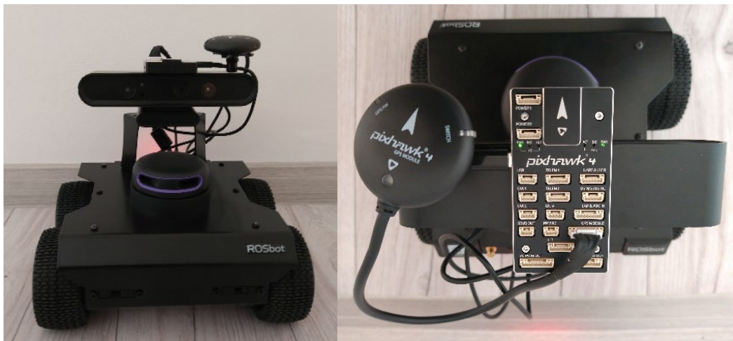
7. ábra: Pixhawk drónvezérlővel és GNSS roverrel felszerelt ROSbot (saját szerkesztés)
