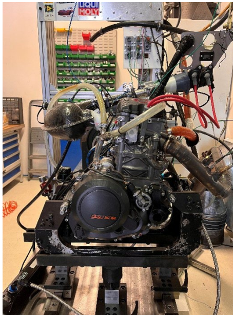
2. ábra: Beépített motor a SZEngine Hallgatói Motorfejlesztő csapat által használt motorfékpadon 58
