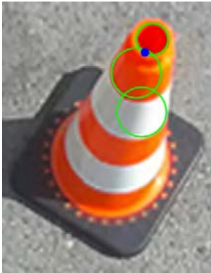
a) Detektált kör alakzatok
