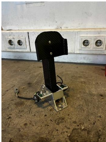
39. ábra. ART_12 gyorsító pedál teljes összeállítás [2]
