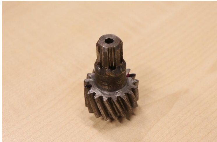
6. ábra. Fogaskerék a hegesztést követően 92
