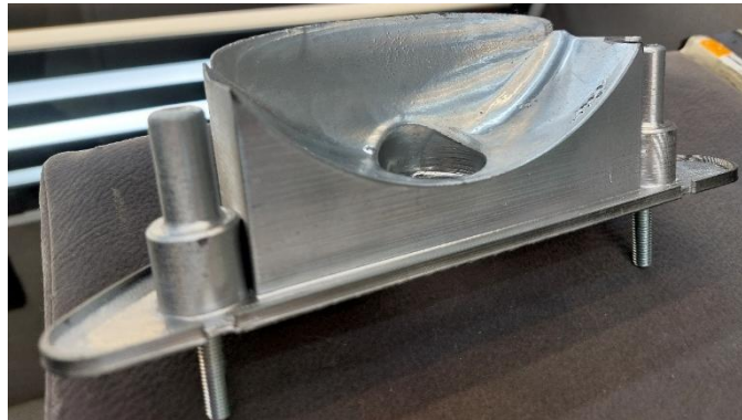
3. ábra. 1000 km-es teszten átesett hátsó lámpatest 147
