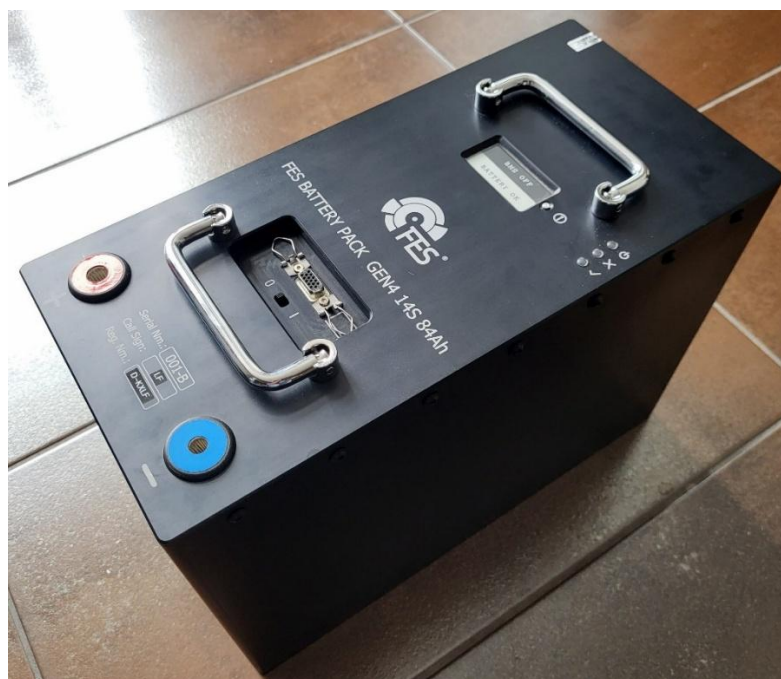
27. ábra: 84 Ah NMC akkumulátorcsomag
