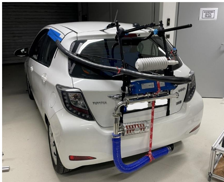
16. ábra: A PEMS rendszer Toyota Yaris-ra szerelve 10
