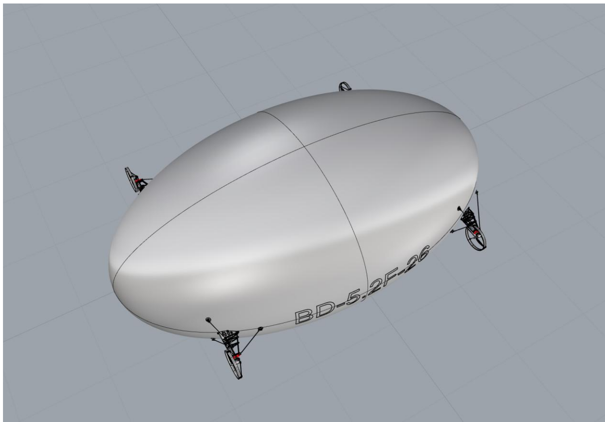
1. ábra. A magaslégtörő mérőlégshajó koncepciója 1
